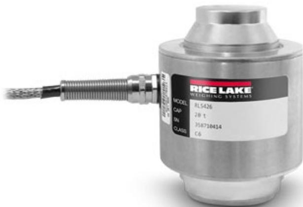
Celle di carico a compressione per pese a ponte omologate CE-M, serbatoi, silos, ecc. Esecuzione in acciaio INOX, con grado di protezione IP69K, 6000 divisioni.
